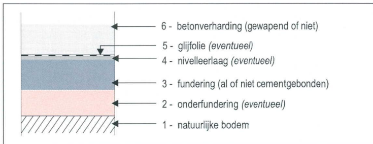
Fig. 1: Opeenvolgende lagen waaruit een bedrijfsvloer is opgebouwd
