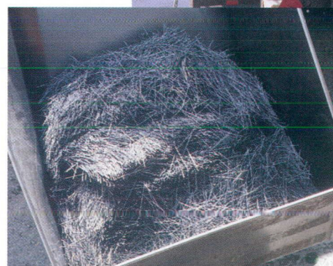
Een schud- en inblaasmachine projecteert de vezels in de mixer
