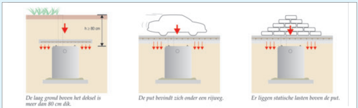
Verdeelplaat in gewapend beton
